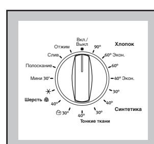
Селектор программ можно поворачивать как по часовой, так и против часовой стрелки.
